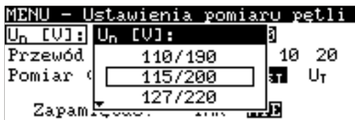
Rys. 9 Wybór napięcia znamionowego sieci
